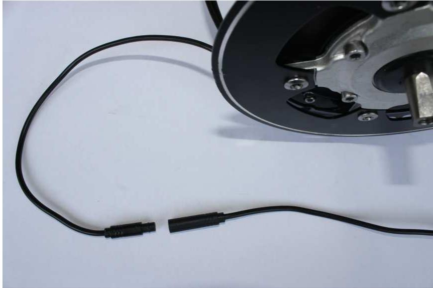
Step 4. Collegare il sensore di velocità con il motore.
